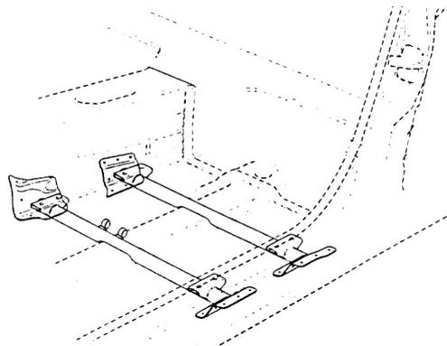
Das verwendete Rohrmaterial muss aus Stahl bestehen und mit einem Durchmesser von mind.  $\varnothing 38$  x 2,5 mm bzw.  $\varnothing 40$  x 2 mm oder mit einem rechteckigen Querschnitt von mind. 35 x 35 x 2 mm ausgeführt sein.
